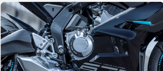
MOTOR TRICILÍNDRICO DE 675CC CON 90HP DISEÑADO Y FABRICADO POR CFMOTO
