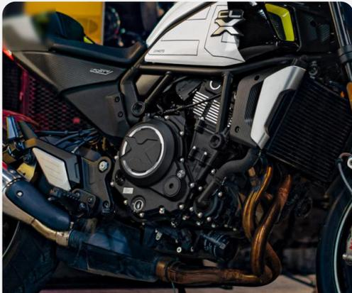
**MOTOR BICILÍNDRICO DE 693 CC
