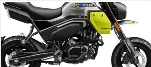
MOTOR MONOCILÍNDRICO DE 124 CC DOHC
