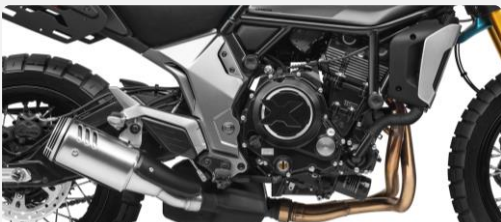
MOTOR BICILÍNDRICO DE 693 CC REFRIGERACIÓN LÍQUIDA
