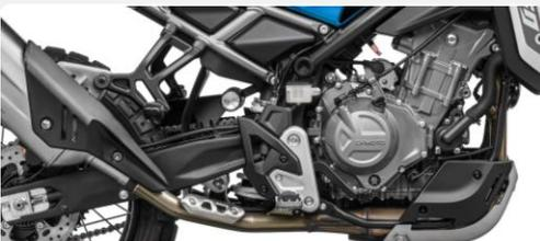
MOTOR BICILÍNDRICO DE 449 CC CON PROTECCIÓN DE SERIE
