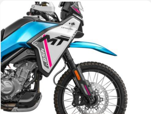
SUSPENSIÓN KYB TOTALMENTE AJUSTABLE CON 200 MM DE RECORRIDO CON DEPÓSITO DE GAS EN LA PARTE TRASERA
