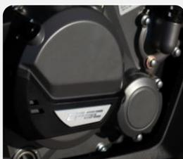
SLIPPER CLUTCH SYSTEM - CF SC
