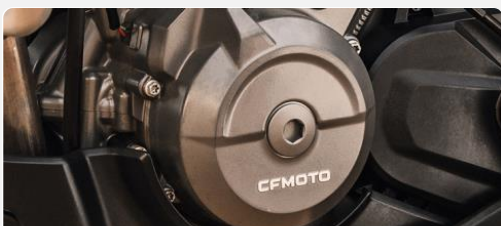
MOTOR MONOCILÍNDRICO DE 249 CC CON REFRIGERACIÓN LÍQUIDA
